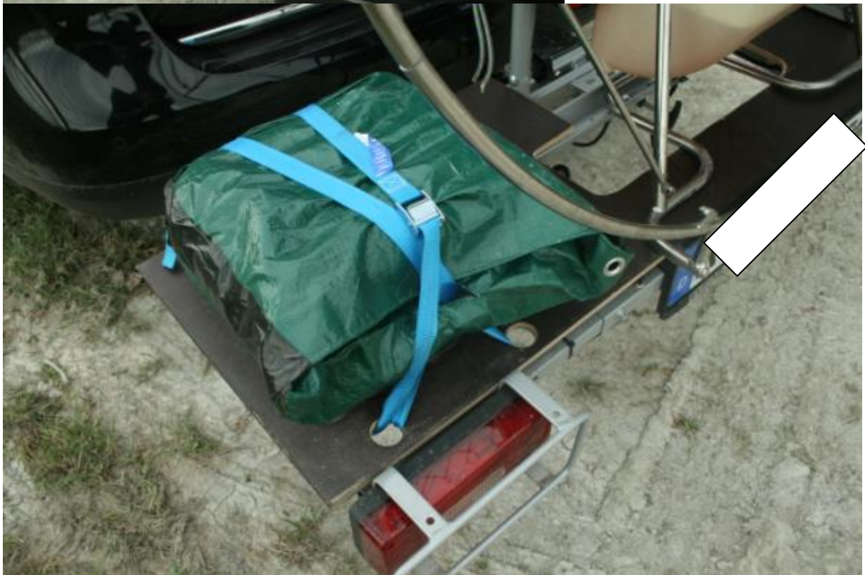
10 | Benzinkanister in Plane verpackt und durch die Bohrungen mit Spanngurt verzerrt
